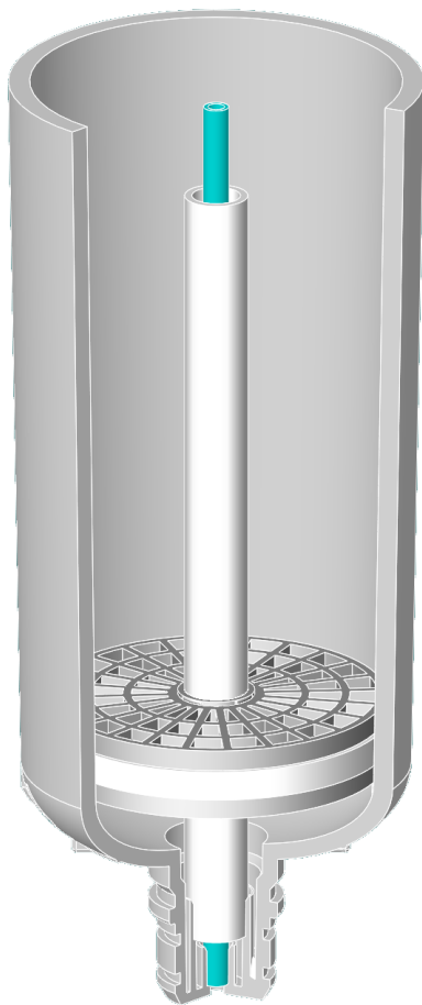
Rysunek 5 Montaż górnego zespołu filtracyjnego
