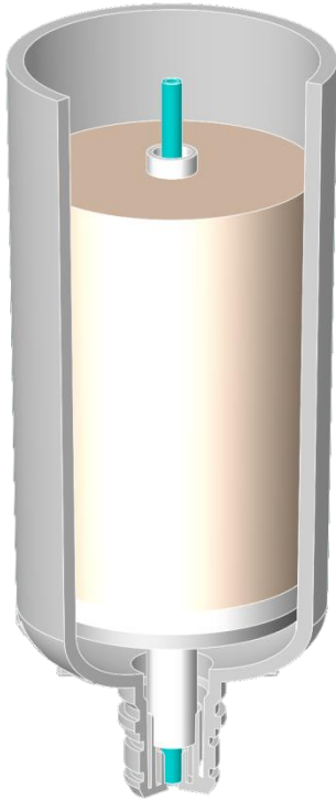
Rysunek 6 korpus wypełniony materiałem filtracyjnym
